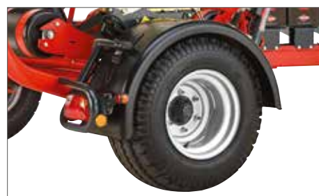
Szerokie błotniki zapobiegają uszkodzeniu folii podczas transportu
