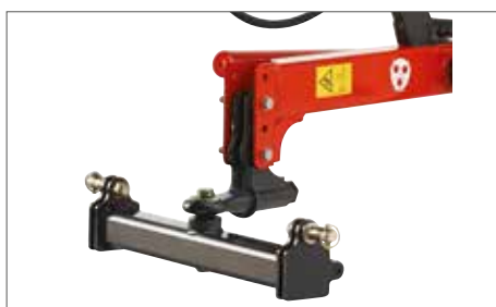
Długi dyszel ułatwia ciągnięcie owijarki w pozycji bocznej przez szerokie/duże ciągniki
