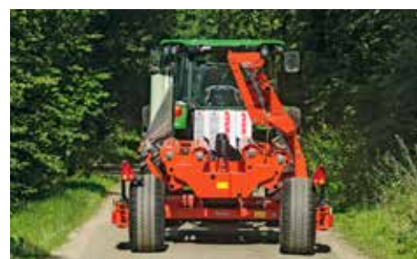
W pozycji transportowej, koła mogą być złożone do wewnątrz, co ogranicza szerokość maszyny. Hydrauliczne składanie jest dostępne jako opcja
