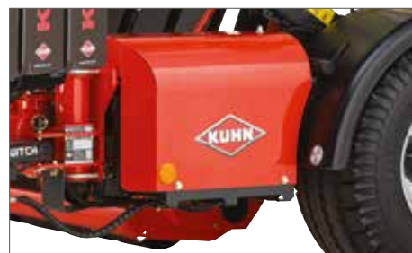
Duża osłona boczna chroni zespół hydrauliczny i zapewnia łatwy dostęp podczas prac konserwacyjnych
