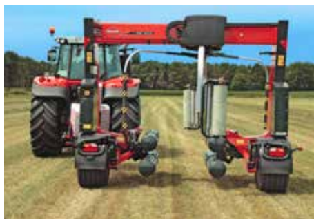
Szerokość owijarki wynosi 4 m podczas pracy w polu i 2,5 m podczas transportu
