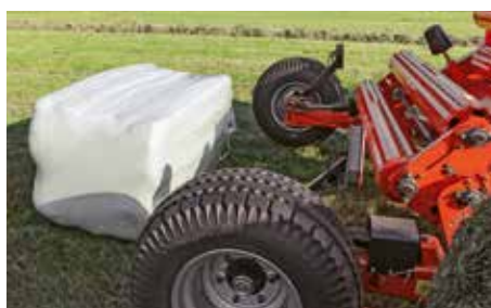
Niskie położenie stołu umożliwia łagodny wyładunek beli na podłoże bez ryzyka uszkodzenia folii
