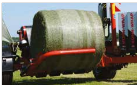
Długie ramię ładujące gwarantuje szybkie i jednocześnie ostrożne podawanie beli
