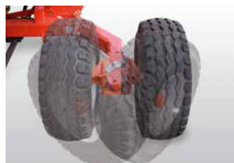
W pozycji transportowej prawe koło może być złożone do wewnątrz. Jako opcja, możliwe jest składanie lewego koła
