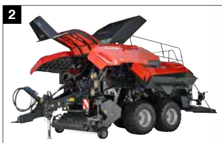
2 Podnoszone schowki na sznurek ułatwiają konserwację
