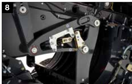
Komora wstępna prasowania POWER DENSITY
