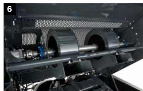
6 Turbiny do czyszczenia aparatów wiążących
