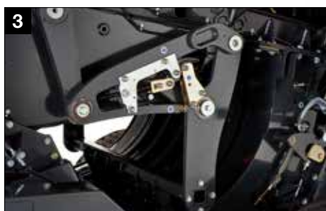
3 Komora wstępna prasowania POWER DENSITY
