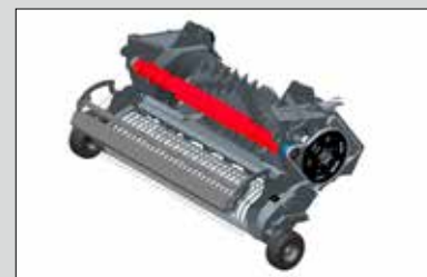
Napędzana rolka przytrzymująca pokos
