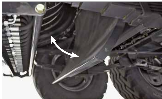
Kłapa kontrolna komory wstępnej prasowania
