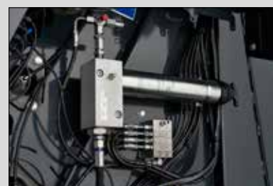
Automatyczny układ smarowania łożysk walców
