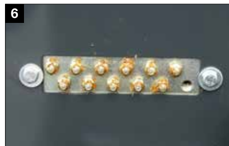
6 Umieszczone centralne porty smarownicze łożysk walców
