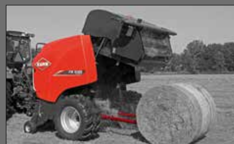
Wyrzutnik bel wykrywa, że beła jest poza zasięgiem. Tylne klapa nie jest otwierana szerzej niż jest to potrzebne. Tylne klapa zamyka się automatycznie
