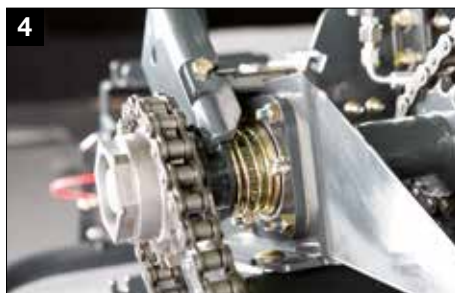
4 Mechaniczne rozłączenie rotora
