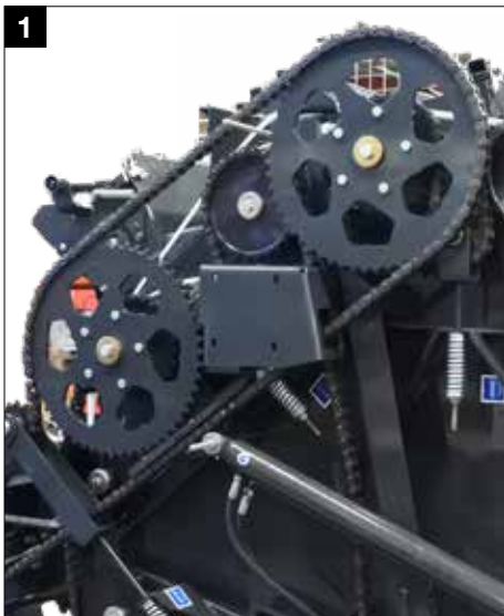
Prosty układ napędowy z jedynie 3 łańcuchami głównymi
