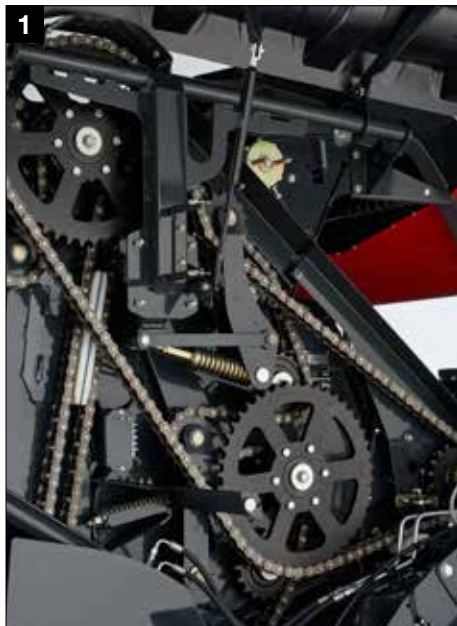
Wzmocniony układ napędowy z wytrzymałymi łańcuchami IWIS
