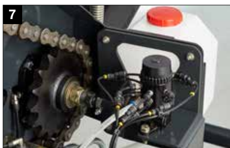
System ciągłego smarowania łańcucha BEKA MAX
