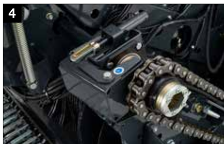
4 Hydrauliczne rozłączenie rotora
