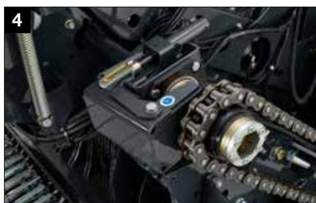
Hydrauliczne rozłączenie rotora
