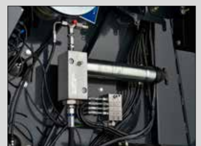
Automatyczny układ smarowania łożysk walców 23
