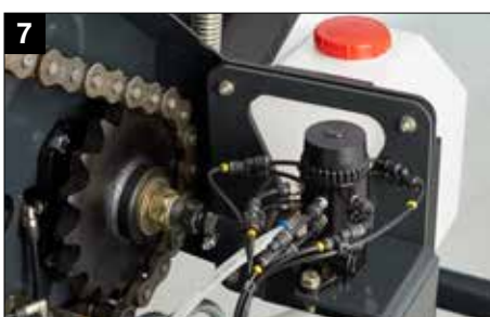
System ciągłego smarowania łańcucha BEKA MAX
