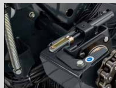
Hydrauliczne rozłączenie rotora
