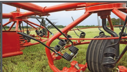
Odporne na przebicia opony z prążkowanym bieżnikiem.
