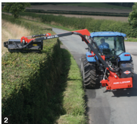
1 i 2. Kosiarki wysięgnikowe o zasięgu poziomym do 7,40 m 3. Rozsiewacze do soli i piasku
