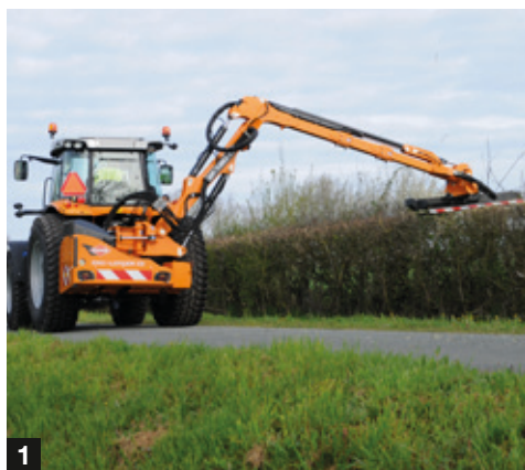
1 i 2. Kosiarki wysięgnikowe o zasięgu poziomym do 7,40 m 3. Rozsiewacze do soli i piasku
